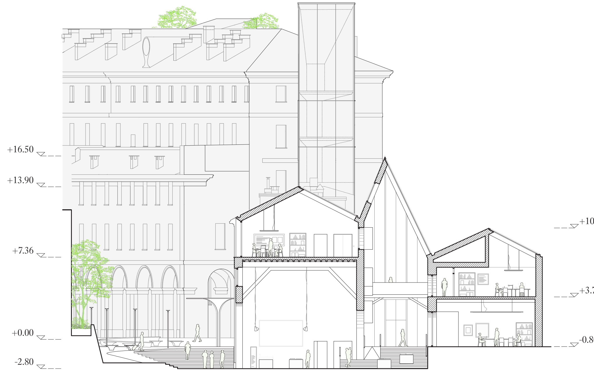
Le Pagliere, sezione trasversale scala 1:200
