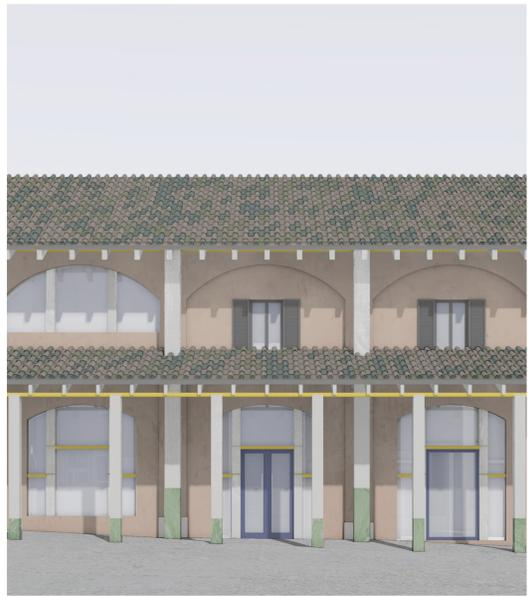
Dettaglio della nuova copertura che sostituisce la parte del Pagliere danneggiata dall'incendio
