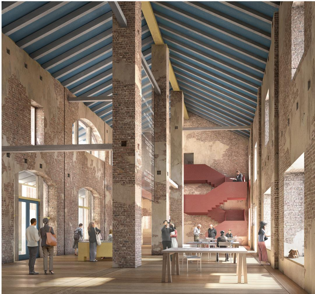
La nuova sala d'ingresso delle Pagine, realizzata all'interno delle vecchie pareti in muratura ripristinate, è uno spazio per esposizioni ed eventi. Una nuova copertura in legno, costruita sulle aree danneggiate dall'incendio, ricopre l'info point e la zona espositiva. La sala d'ingresso si affaccia sul lungo cortile centrale delle Pagine con i suoi laboratori e workshop al piano terra.
